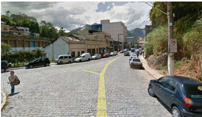
Fig. 38 - Exemplo de trecho onde meio-fio pode ser redefinido de forma a ampliar as calçadas, reduzindo caixas de rolamento.
